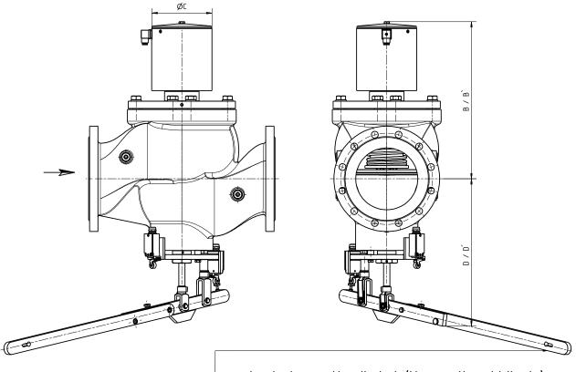
–abnehmbarer Handhebel (Nennweitenabhängig) detachable hand lever (depending on nominal witdh)
